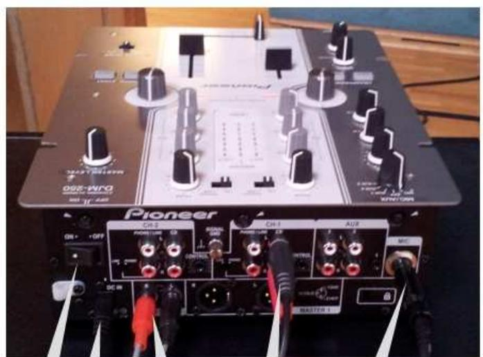
Type IN: Steht immer auf der Position, die zum Anschluss des Laptops passt. In der Regel auf „CD“. Der Laptop wird an einem Kopfhörerausgang angeschlossen.
